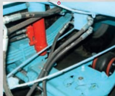
Sospensioni a balestre con bloccaggio idraulico dell'oscillazione
