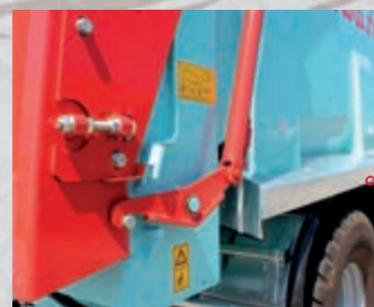
Portellone posteriore con aggancio a comando idraulico e guarnizione a tenuta stagna
