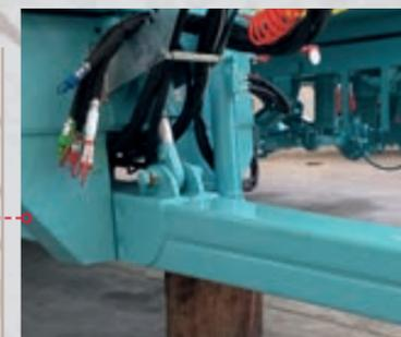
Timone sospeso idraulicamente con compensatore ad azoto
