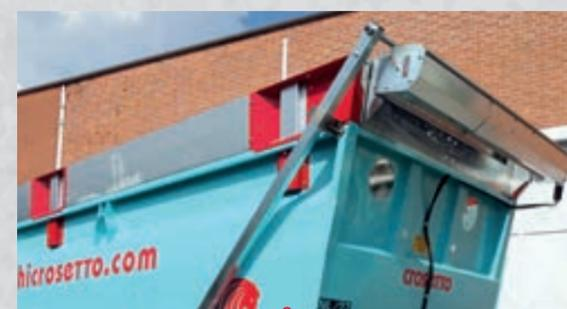
Sovrasponde in acciaio zincato con profilo per impedire l'accumulo accidentale di materiale
