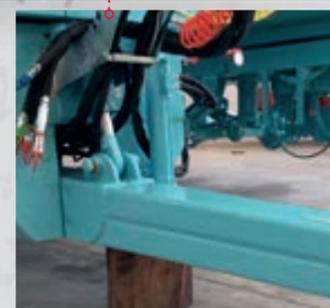
Timone sospeso idraulicamente con compensatore ad azoto
