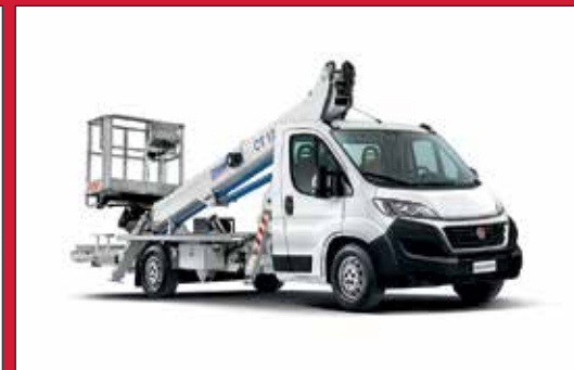
Ducato Cabinato - allestimento piattaforma aerea.
