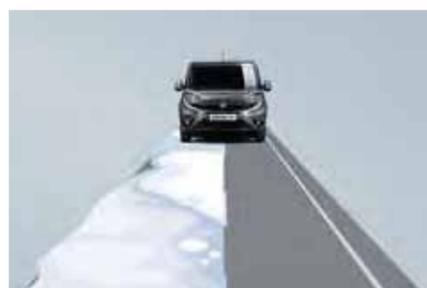
Il **Traction+** è l'innovativo sistema di controllo della trazione che incrementa la motricità del veicolo su terreni difficili e a scarsa aderenza. In condizioni di bassa aderenza su una ruota motrice, la centralina del sistema rileva lo slittamento e la frena, trasferendo la coppia motrice sulla ruota con maggiore presa sul terreno. In questo modo il disimpegno del veicolo diventa più agevole assicurando la migliore guidabilità e stabilità direzionale possibile.
